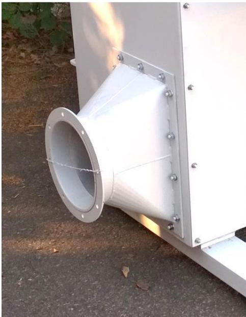
Montiert Übergangstück ohne Isolierung.
