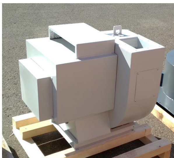
Namontovaný protihlukový kryt na volně stojícím ventilátoru
