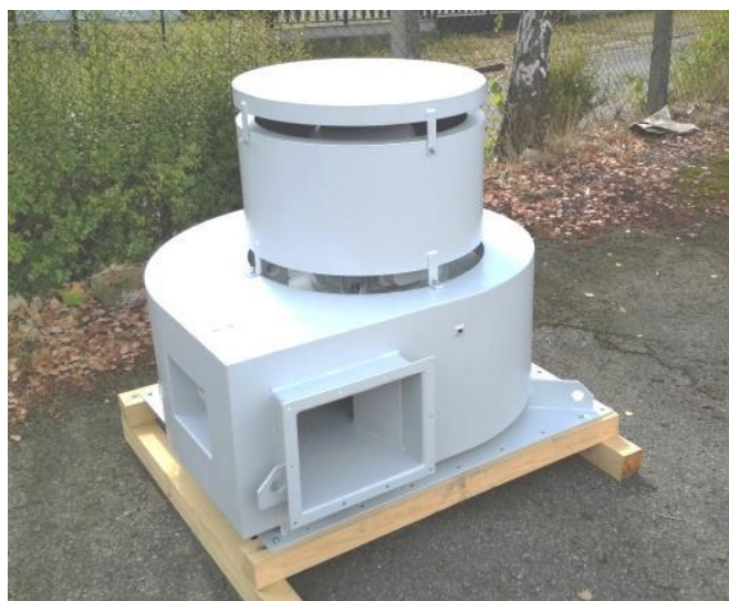
Namontovaný protihlukový kryt na vestavěném ventilátoru
